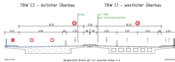
Regelquerschnitt C4 östliche Rampe
