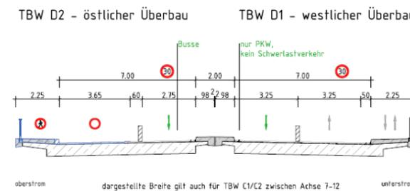
Regelquerschnitt C3 westliche Rampe
